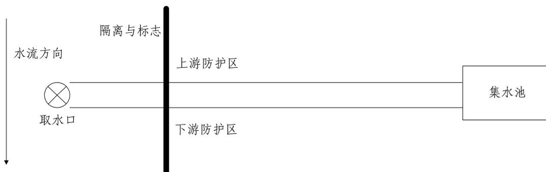
图 1 河流、湖库水源保护工程示意图
